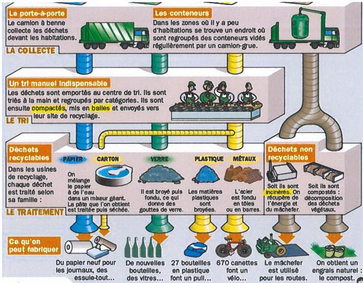
Les centres de tri sont des installations où les déchets issus des collectes sélectives sont triés plus précisément, conditionnés et stockés avant d'être recyclés.
