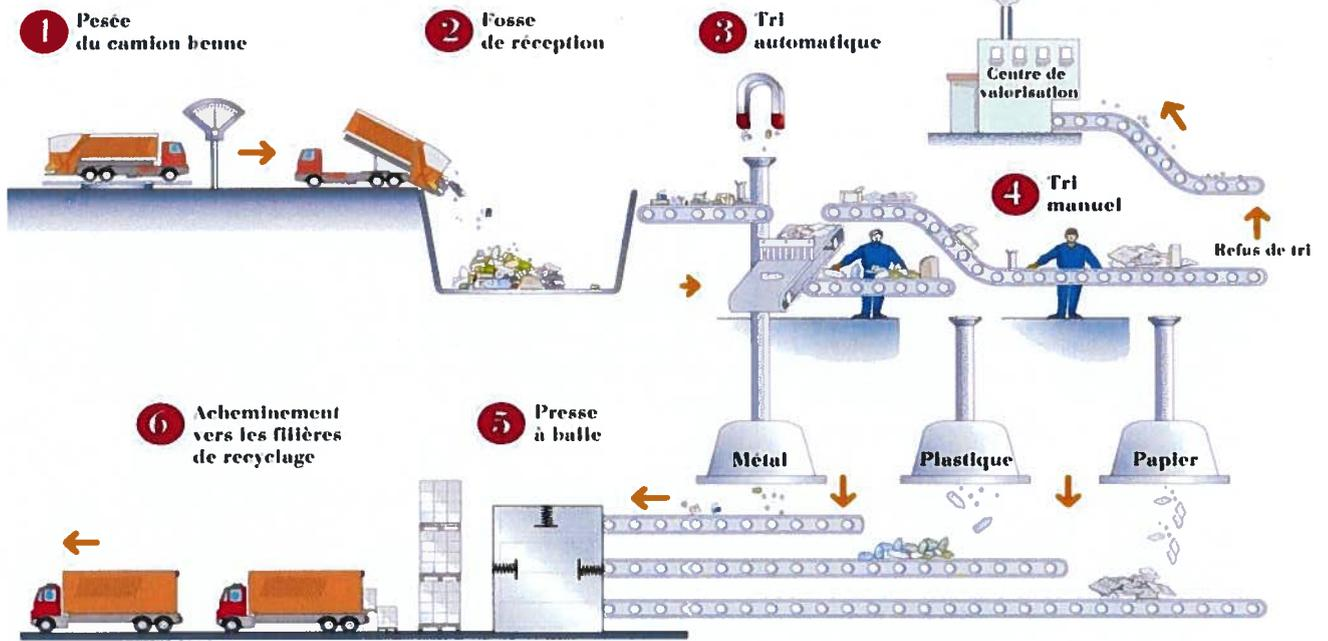
Figure 8 : Schéma de fonctionnement d'un centre de tri
